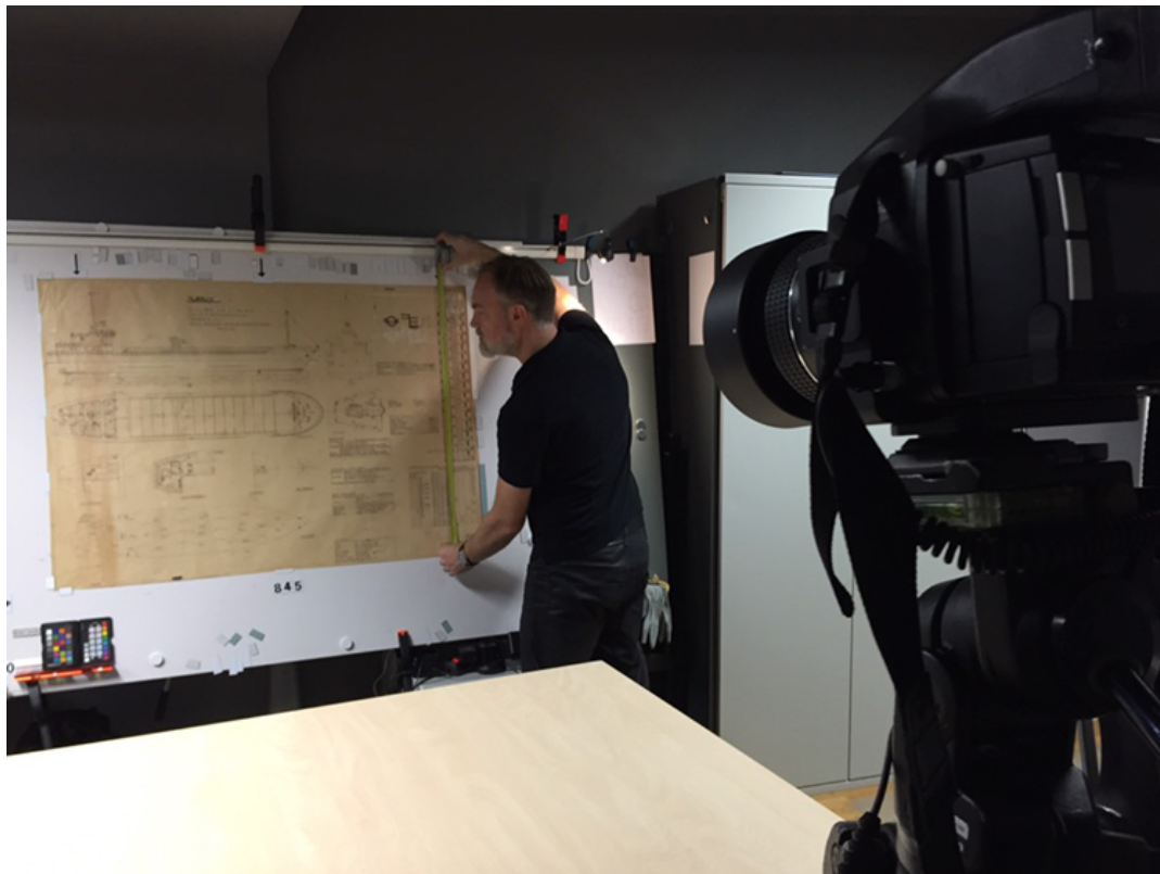
Digitalisering ved bruk av digitalt mellomformatkamera for store format. Originalene festes ved hjelp av magneter på magnetisk tavle.
